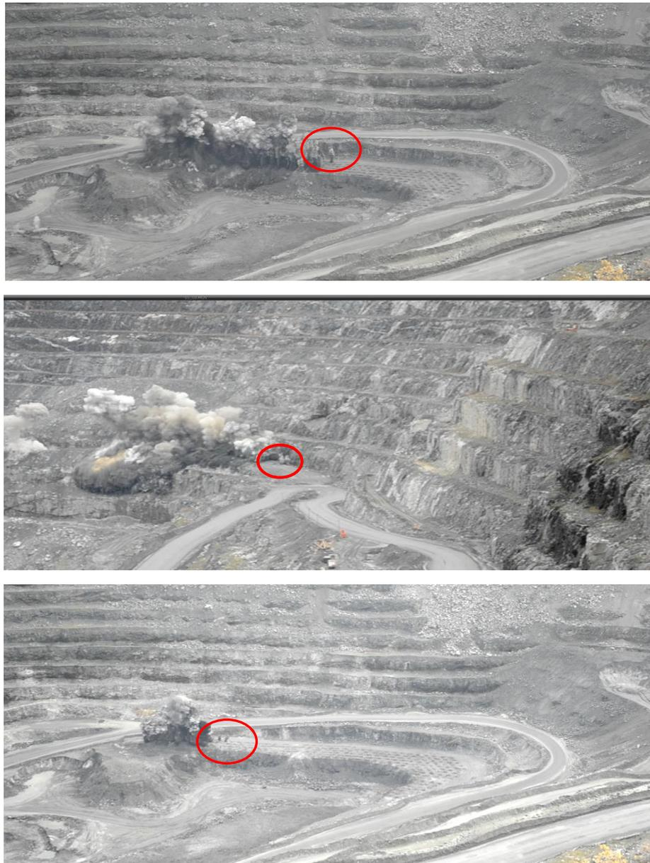
Рисунок 3.3 – Примеры опережающего взрывания скважин при поперечной схеме развития взрыва
